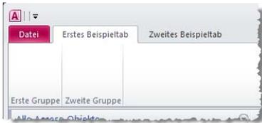
**Abbildung 12.17:** Ein *tab*-Element mit zwei *group*-Elementen
