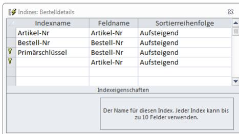
**Abbildung 1.16:** Beispiel für einen zusammengesetzten Schlüssel im Indizes-Dialog
