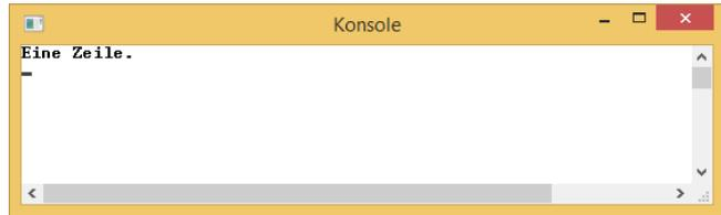
**Bild 2:** Ausgabe einer kompletten Zeile mit `WriteLine`
